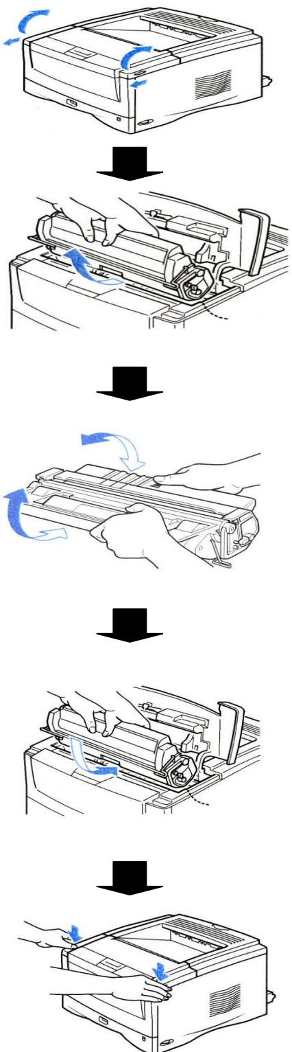
1. プリンターを停止し、上カバー両側面の上カバー開閉ラッチを前側に引いて、上カバーを開けます。
