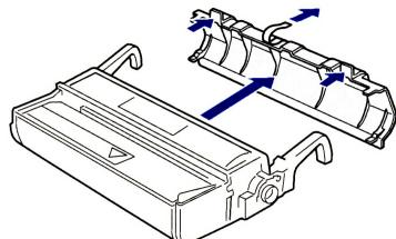
6. カートリッジの両側の突起を本体内側のがたに合わせて、ゆっくり水平に押し込みます。
