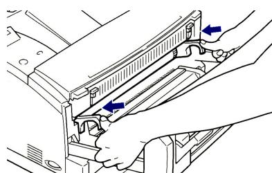
8. 前カバーを閉じ、左右のレバーを上げてロックします。
