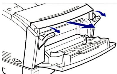
3. 使用済みのカートリッジの左右の取っ手を持ち、水平に引き出します。
