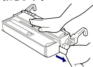
5. 保護カバーを止めているテープを取り、2箇所のレバー部分を押して、保護カバーを取り外します。
