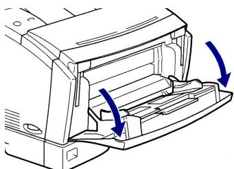
2. 左右の開閉レバーを下げる、前カバーを引きだします。
